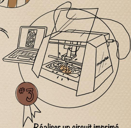
Réaliser un circuit imprimé avec une fraiseuse numérique
